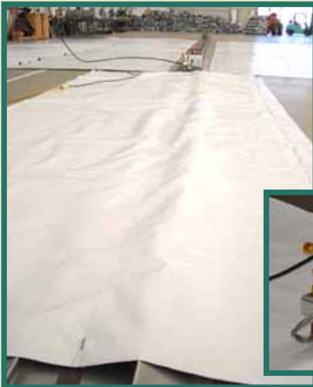
PE Hay Cover Welding, USA
